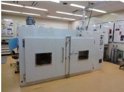
ガス-油のように2つの異なる流体が貯留層内を流動するときには、孔隙中に占める流体の比率（飽和率）により浸透率が変化します。本装置ではそれぞれの浸透率（相対浸透率）を貯留層を模擬した流動実験（コアフラッド実験）により評価します。
