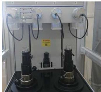
岩石はさまざまな大きさの孔隙から形成されており、浸透率などの岩石特性に影響します。本装置では水銀と空気の毛細管圧力の関係から孔隙の大きさ（孔径）の大きさと量を求めることができます。
