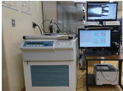
貯留岩は多孔質媒体であり、ガス-油のように2つの異なる流体間には毛細管圧力が働きます。毛細管圧力は貯留層内の流動や流体飽和率分布にも影響し、主に遠心分離方式の測定装置にて評価します。
